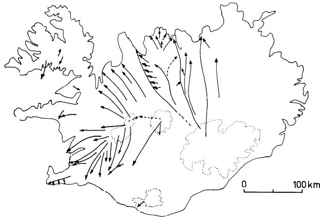
Abb. 5.36. Die Einzugsgebiete und das allgemeine Netz der thermalen Grundwasserfließsysteme in Island, aufgrund von Deuterium-Messungen. (Nach A. HJARTARSON 1980)
